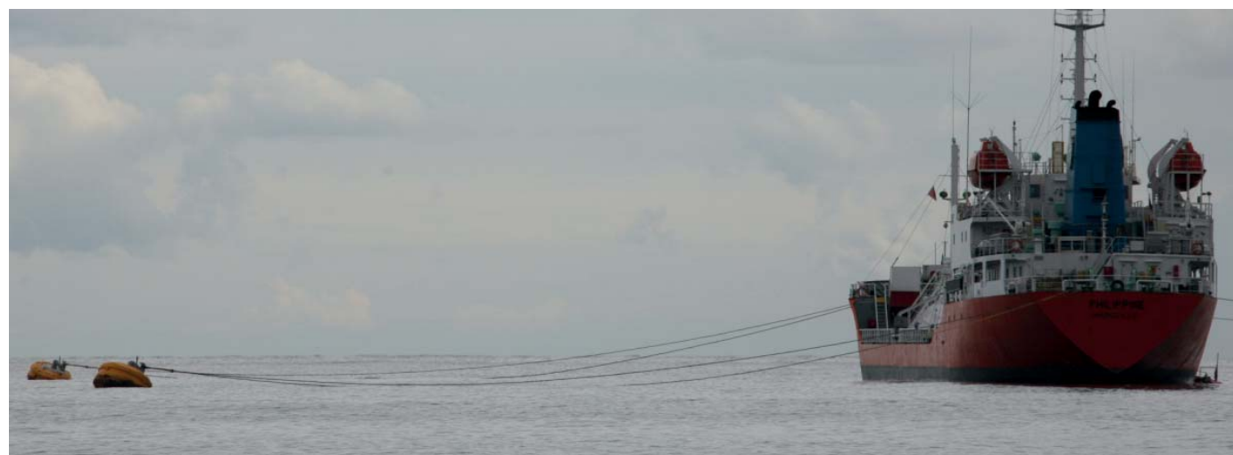
Coffres AMR 9000 en opération en mer Méditerranée / Mooring buoys in operation in Mediterranean sea
